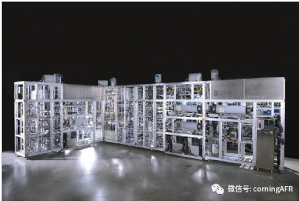
圖1為最近批准的多步合成工藝生產原料藥丙酸氟替卡松的連續生產裝置
